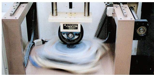
回転摩擦促進試験 負荷荷重 56kg
