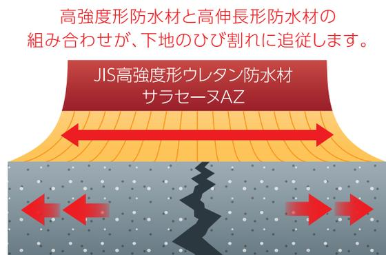
高強度形防水材と高伸長形防水材の組み合わせが、下地のひび割れに追従します。
