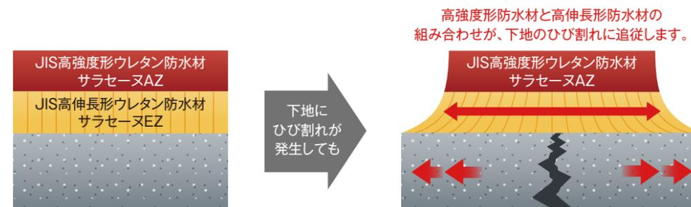
既存ウレタン防水層の塗り重ねにおいても高強度形防水材を使用することで同様の防水層を形成できます。(イメージ図)
