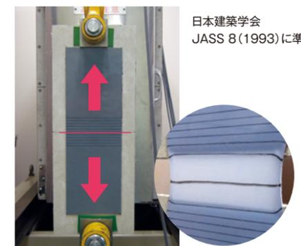
堅鎧工法は、補強布なしでも、X-2相当工法以上の性能を有していると言えます。
