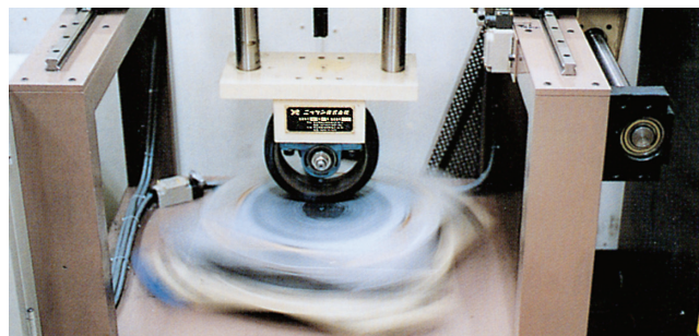
回転摩耗促進試験 負荷荷重 56kg 単位面積荷重 0.735N/mm 2
